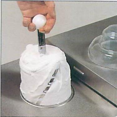
**AGITATORE** verticale che a fine ciclo si sfilata completamente dalla macchina per estrarre il gelato.
